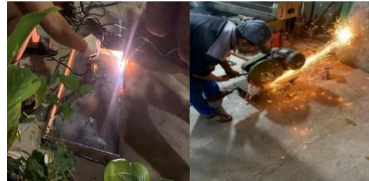
Gambar 12. Proses Pemotongan Bahan Awal dan Pengelasan
