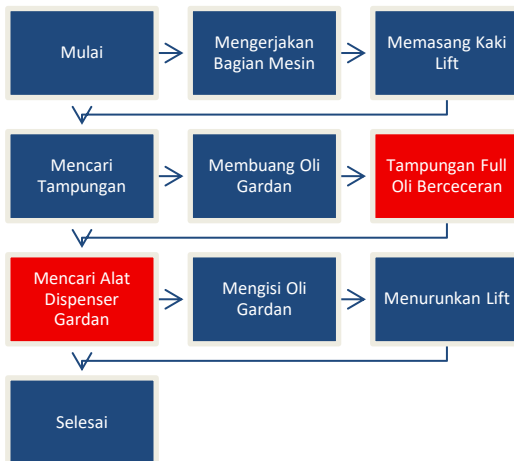
Gambar 4. Flowchart Penggantian Oli Gardan
