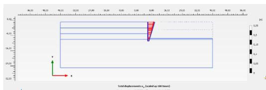
Gambar 10. Horizontal Displacement pada Soldier Pile
