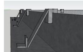
Gambar 8. Detail Penguat Samping Bekisting Pelat
