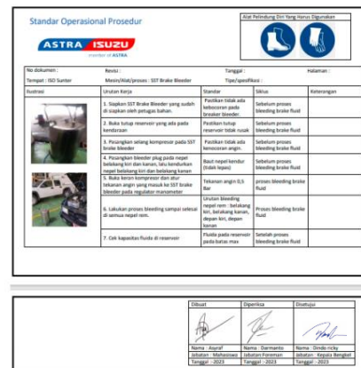
Gambar 6. SOP Penggunaan Brake Bleeder
