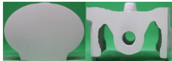
Gambar 14. Hasil Penetrant Test Setelah Modifikasi
