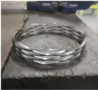
Gambar 19 Kondisi *Spring Piston Brake no1* Setelah Uji Coba.
