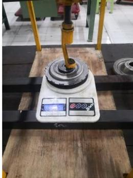
Gambar 11. Proses Penekanan Spring Pada Timbangan
