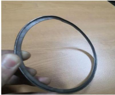
Gambar 3. *Spring Shim* Cacat
