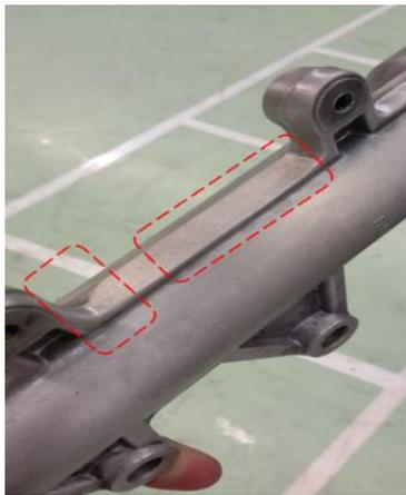
Gambar 3. Cacat gelombang *rib*
