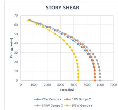
Gambar 6. Gaya gempa dasar sistem struktur SPSW dan CSW terhadap beban gempa arah-x dan arah-y
