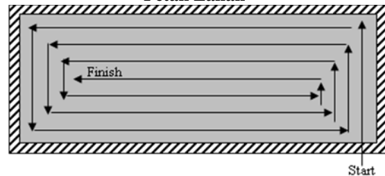
Gambar 5. Ilustrasi arah gerak kerja pemotongan mesin panen pada lahan
