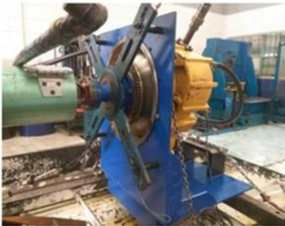
Gambar 5. Uji coba alat bantu pengujian *Torque Converter*
