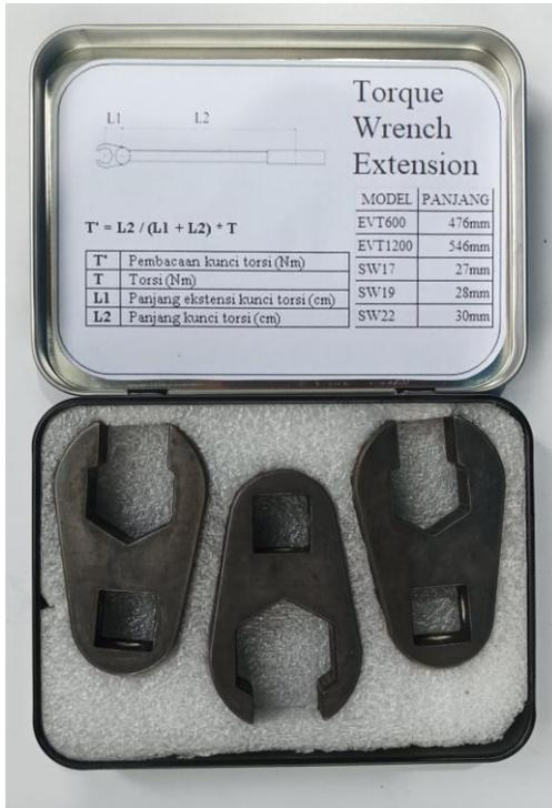
Gambar 8. *Torque Wrench Extension* yang Telah Melewati Proses Manufaktur.
