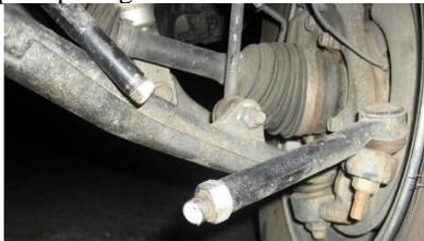
Gambar 1. Patah *Tie Rod* pada Kendaraan (sumber: autotrends.org)
