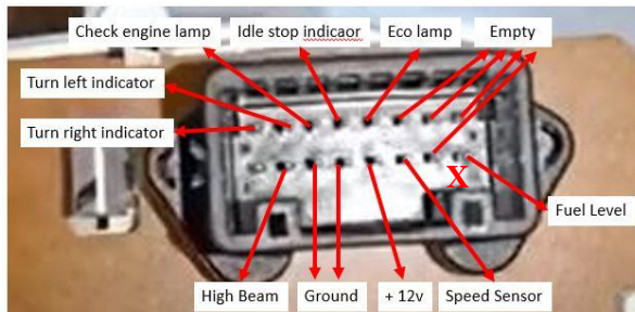
Gambar 3. Pinout display dan keterangannya
