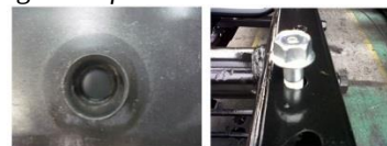
Gambar 4. 5. Jenis Defect Outflow : Hole Tidak Center
