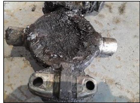
Gambar 3. *Spider bearing* aus
