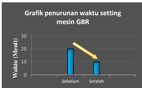
Gambar 4.10 Grafik penurunan waktu setting mesin GBR
