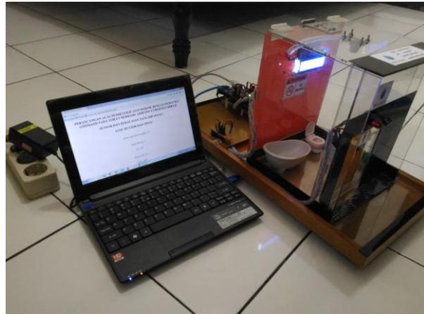
Gambar 8. Alat Pendeteksi Asap Rokok Dengan Pengunci Otomatis Pada Toilet Berbasis Arduino Mega Ethernet Shield
