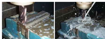
Gambar 4. Proses *Milling* Pemakanan Muka (*Facing*)
