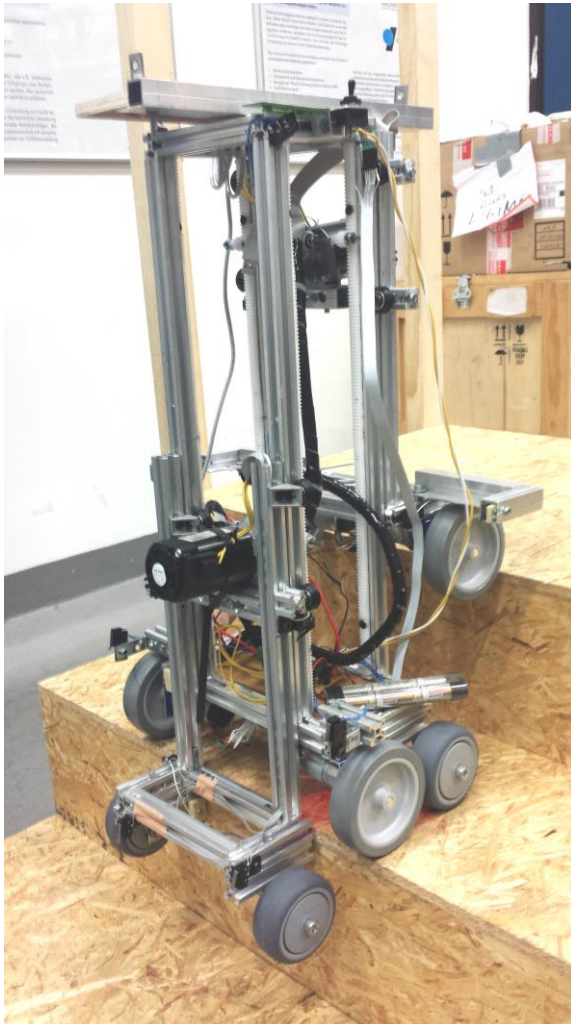
Gambar 10. Foto robot saat uji coba menuruni tangga
