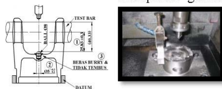
Gambar 3.8 Bagian part yang Akan di Drilling
