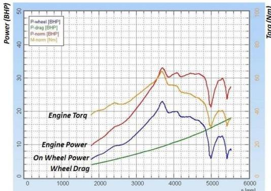
Gambar 5: Tenaga keluaran mesin Toyota 4K pada perbandingan kompresi 13:1 dengan injeksi air
